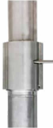
Für die Montage wird die Verwendung eines geeigneten Gleitmittels mit KTW-Zulassung empfohlen. Mit Hilfe der im Lieferumfang enthaltenen Schrauböse können die Edelstahl-Scherfedern bei der Demontage wieder gezogen werden. Beim Aus- und Wiedereinbau der Steigleitung sind die Scherfedern auf Beschädigungen zu prüfen und die O-Ringe zu erneuern. Zum Lösen der Verbindung wird eine Ösenschraube mitgeliefert, mit derer die Spiralfeder gezogen werden kann.
