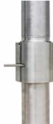
Für die Montage wird die Verwendung eines geeigneten Gleitmittels mit KTW-Zulassung empfohlen. Sie erfolgt mit der Muffe nach oben zeigend. Mit Hilfe der im Lieferumfang enthaltenen Schrauböse können die Edelstahl-Scherfedern bei der Demontage wieder gezogen werden. Beim Aus- und Wiedereinbau der Steigleitung sind die Scherfedern auf Beschädigungen zu prüfen und die O-Ringe zu erneuern.
