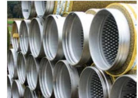
GWE verwendet ausschließlich besonders hochwertigen Filterkies nach DIN/EN und trinkwasserzugelassene Harze als Klebstoff.
