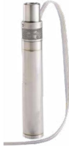
Der Motor ist ein flüssigkeitsgefüllter Spaltrohr-Unterwasser-motor. Die Stromversorgung erfolgt über ein Teflon-Kabel. Das Kabel ist auswechselbar und in drei Längen lieferbar. Der Frequenzumformer ist speziell für den Einsatz der MP 1 konstruiert und enthält den Motorschutz für die Pumpe.
