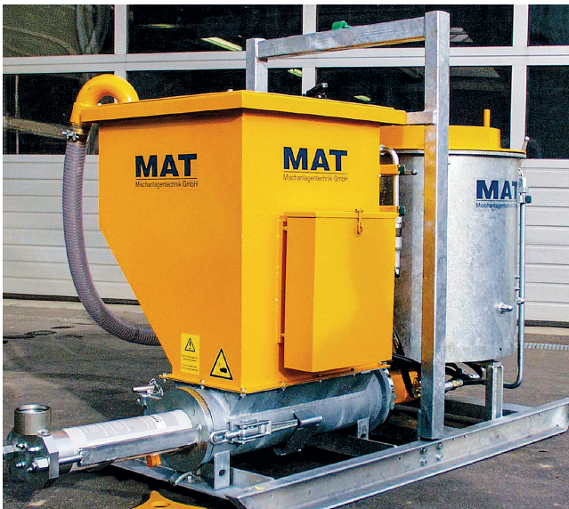
Misch- und Verpressanlagen der MAT Slurry Handling Systems gewährleisten die Herstellung stabiler Suspensionen bei effizientem Materialeinsatz.
