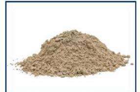
Mit Wasser angemischt werden hiermit pumpfähige Suspensionen hergestellt, die im Kontraktorverfahren bis in große Bohrteufen sicher platziert werden können. In der Regel umhüllen diese dann als Komplettabdichtung die Vollwandrohrstrecken bis Zutage.
